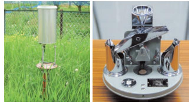
▲転倒ます型雨量計 0.5mmの雨水がたまと、ますがたおれて、雨水を排出する。そのたおれた回数が記録されて雨量が計算される。写真右は分解したところ。
