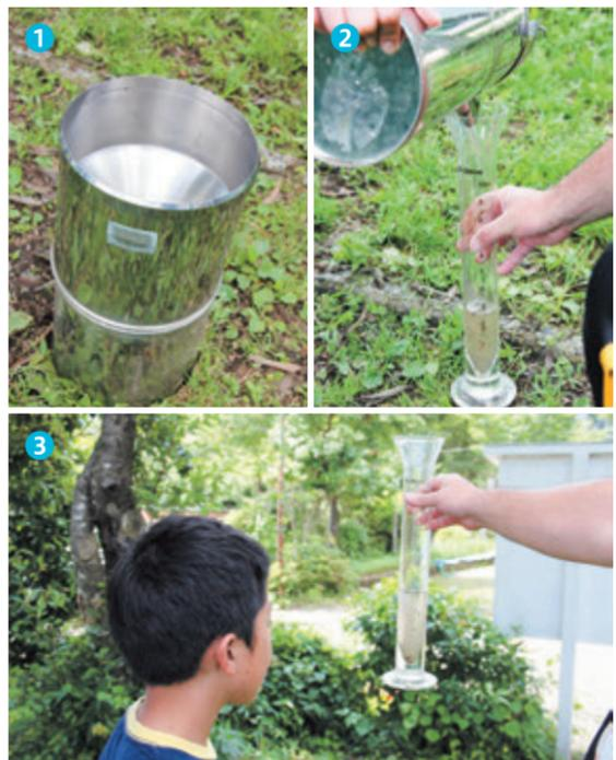
◀貯水型雨量計 ①雨量計の受水器。②受水器の中の貯水びんから、雨量ますに水を移す。③雨量ますの目もりを読んで雨量を記録する。
